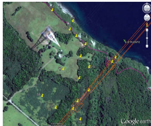
Figura 3. Distribución espacial de puntos de microvibraciones ambientales. Acceso Sur.
